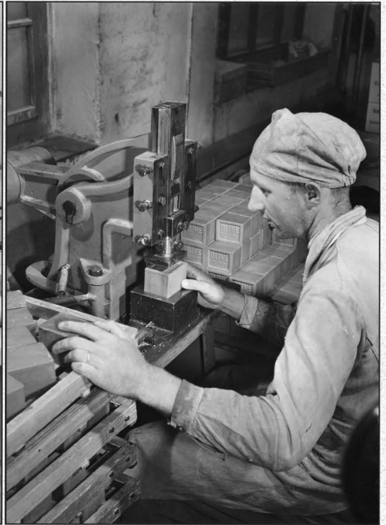
Blinde Arbeiter an der Waschpulver-Abfüllmaschine und beim Prägen der Seifenstücke
